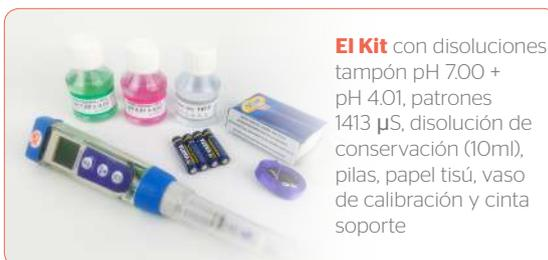
**El Kit** con disoluciones tampón pH 7.00 + pH 4.01, patrones 1413  $\mu$ S, disolución de conservación (10ml), pilas, papel tisú, vaso de calibración y cinta soporte
