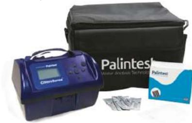
**¿Como funciona?** Esta tecnología ofrece ventajas significativas en comparación con las técnicas tradicionales, mediante sensores desechables de un solo uso, que junto a los instrumentos Palintest, utilizan la cronoamperometría y la electroquímica para medir la corriente eléctrica generada por las reacciones químicas.
