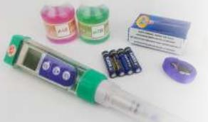
**El Kit** con tampones de pH 4.01 y pH 7.00 (55ml), disolución de conservación (10ml), pilas, papel tisú, vaso de calibración y cinta soporte
