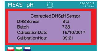
Los nuevos electrodos de pH DHS no tienen batería interna, por lo que pueden almacenarse como un electrodo de pH normal y no utilizan conectores especiales, sino el BNC estándar.
